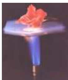
Rysunek 6.65: Aerożel jest doskonałym termoizolatorem (JPL/NASA)
