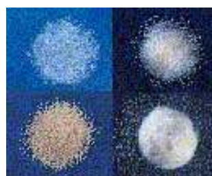
Rysunek 6.67: Nanożel: 4 rodzaje granulek (www.nanogel.com)
