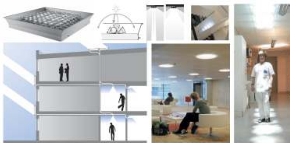
Rysunek 6.117: Parans Daylighting System umożliwiający transport skupionego światła słonecznego poprzez światłowody do emiterów w pomieszczeniach (Parans Daylight AB)
