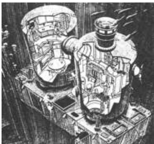
Rysunek 5.19: Habitat podwodny Tektite – widok z pokazaniem wnętrza (Gussmann 1984)
