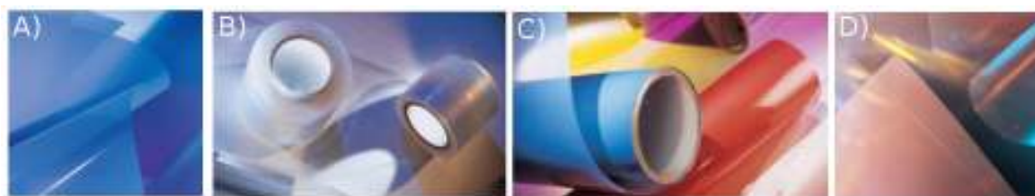
Rysunek 6.72: Folie z tworzyw sztucznych: A) ECTFE, B) PVDF, C) ETFE, D) PFA (DuPont)
