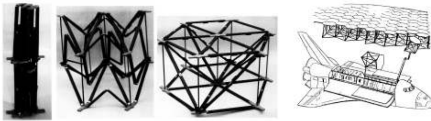
Rysunek 6.10: Rozkładający się moduł anteny słonecznej nadający się do montowania przez wysięgnik Space Shuttle (Hedgepeth i Miller 1987)
